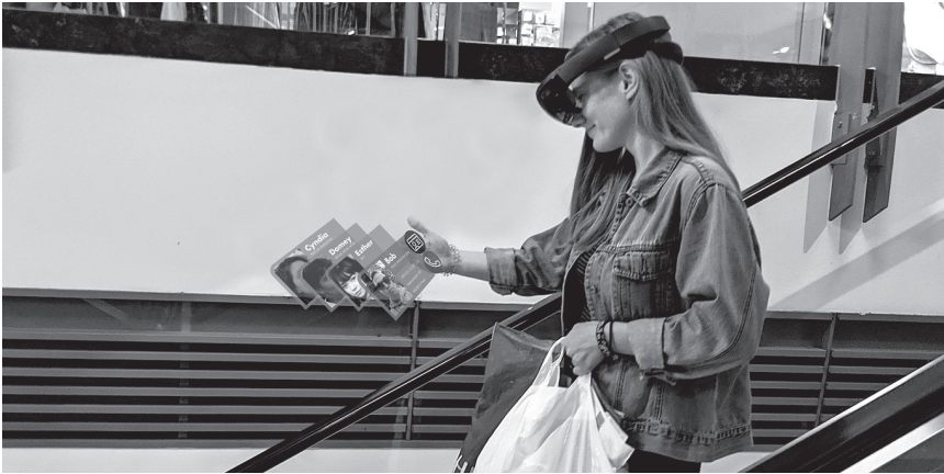
Abb. 1: Proximity-based Interaction erlaubt die mobile und einhändige Interaktion mit digitalen Informationen durch Bewegungen der Hand entlang der Sichtlinie des Nutzers.
